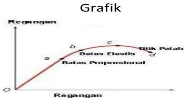
**Gambar 8.** Grafik hubungan antara tegangan dan regangan benda.
