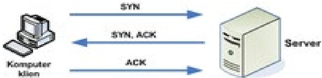
Proses pembuatan koneksi (TCP Three way handshake)
