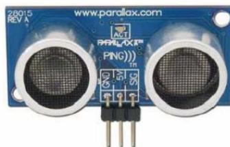
Gambar 2.12. Sensor Ultrasonik [1][11]
