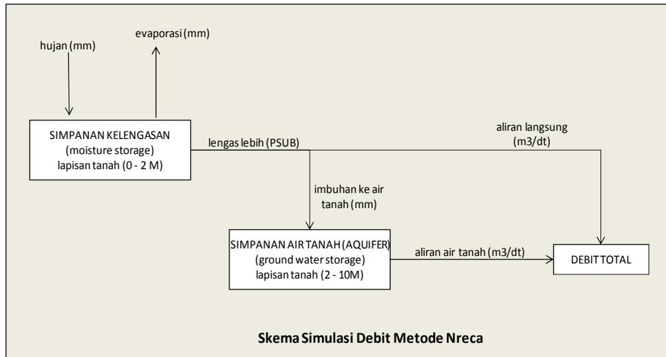
**Gambar A.3.5. Skema Simulasi Debit Metode Nreca**
