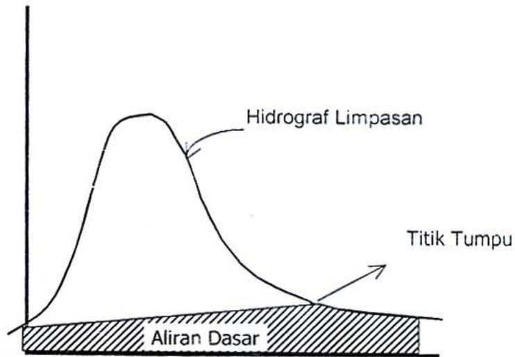
Gambar A.1.11 Debit aliran dasar ditarik dari titik permulaan hujan sampai titik belok di akhir hidrograf satuan
