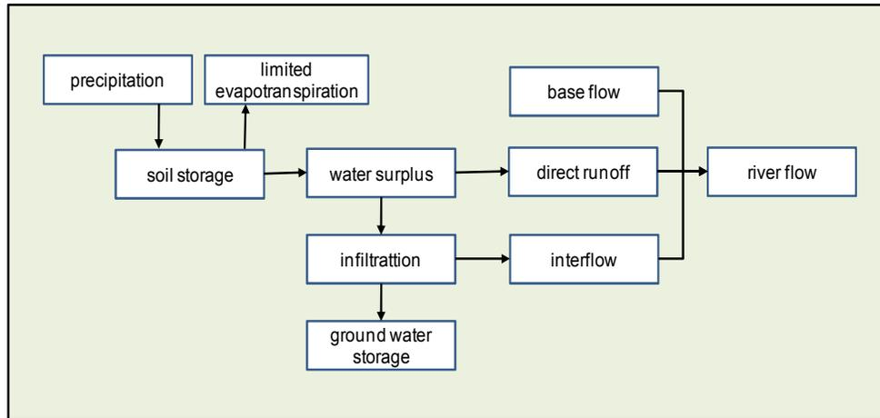
**Gambar A.3.4. Skema Simulasi Debit Metode Mock**
