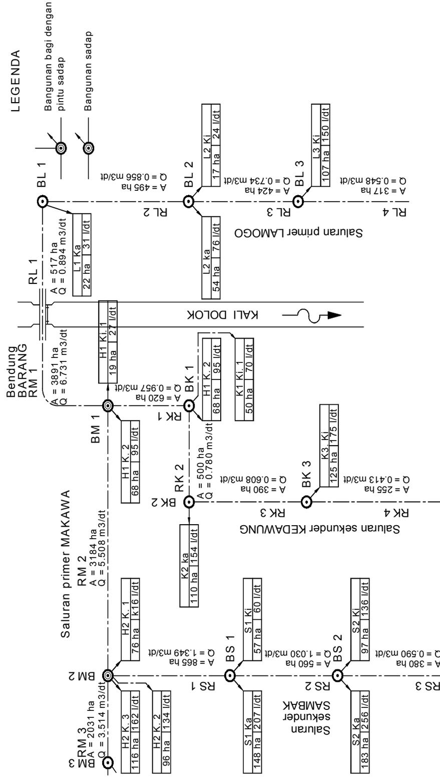
Gambar 2.2 Standar sistem tata nama untuk skema irigasi
