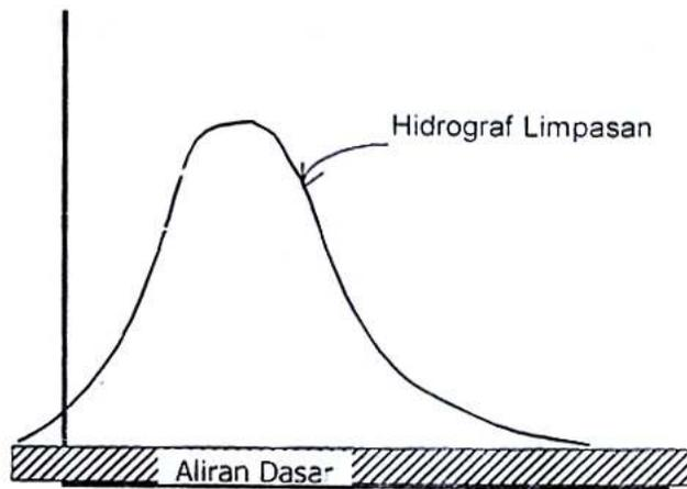
Gambar A.1.10 Debit aliran dasar merata dari permulaan hujan sampai akhir dari hidrograf satuan
