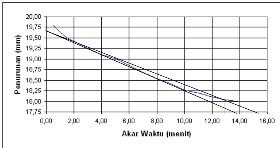
Gambar CVI. 5 Curva hubungan akar waktu dengan penurunan
