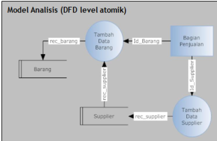
Gambar 5.10 DFD level atomik pada model analisis
