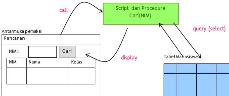
**Gambar 5.2** Mekanisme dan relasi antar komponen perangkat lunak.
