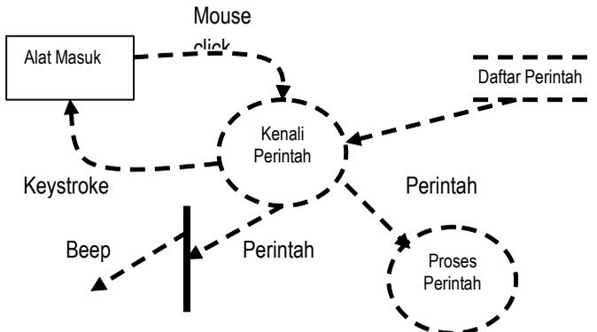
**Gambar 5.9 Contoh Penggambaran CFD untuk Pemrosesan Perintah**
