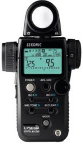
**Lightmeter** Adalah alat uji yang berfungsi sebagai pengukur intensitas cahaya, **Lightmeter** sendiri terdapat 2 jenis **lightmeter**, yaitu Reflected **lightmeter** dan Incident **lightmeter**. Reflected **lightmeter** adalah sebagai sistem pengukuran cahaya di dalam sebuah kamera serta bisa diaktifkan pada **lightmeter** eksternal.
