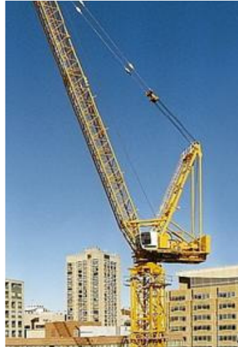
b. Crane Kolom Putar , digunakan untuk konstruksi bangunan tinggi
