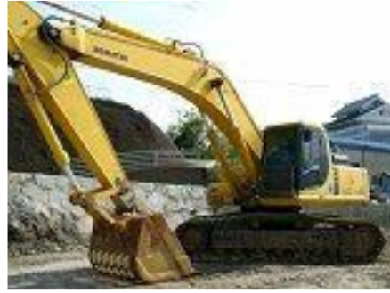
b. Crawler Back Hoe ( Back Hoe yang menggunakan roda rantai)
