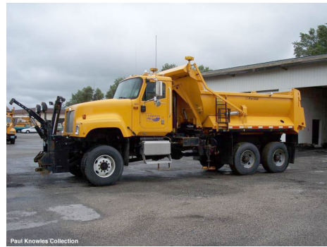
b. Dump Truck , sisi bak truck dapat diangkat secara hidrolis untuk menumpahkan muatannya.
