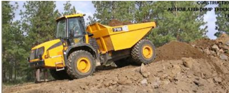
a. Dump Truck ukuran kecil (Kapasitas 18 Ton)
