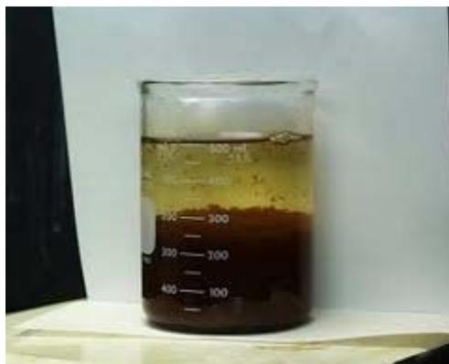
Gambar 5. Tahapan pengendapan partikel dalam sedimentasi
