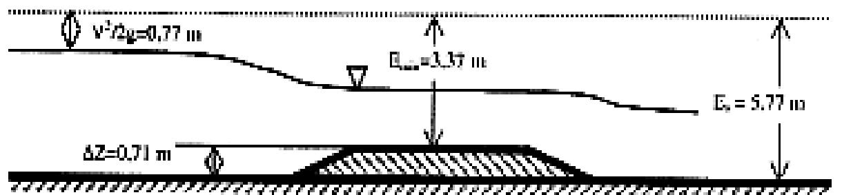
Diasumsikan tidak ada kehilangan energi sepanjang segmen saluran yang ditinjau, dengan demikian tidak terjadi perubahan tinggi energi,  $E_{\min} = E$ .
