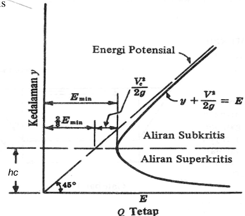
1. Sebuah saluran segi empat lebar 3 m, mengalir debit 11.3 m<sup>3</sup>/det, tabulasikan kedalaman aliran terhadap energi spesifik untuk kedalaman 0,3 m sampai 2,4 m
