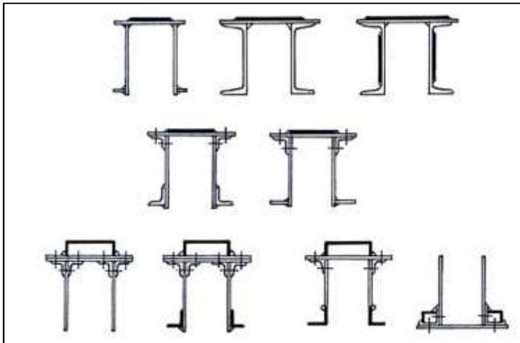
Gambar 5 - Perkuatan dengan memperbesar penampang bawah dengan pelat baja tambahan pada gelagar baja
