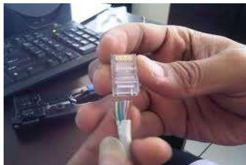
Gambar poisisi RJ 45 saat memasukan kabel
