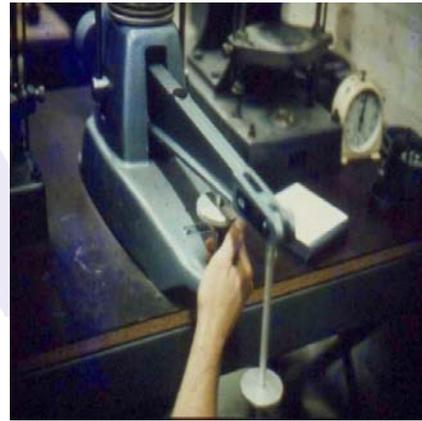
Gambar A.6 Penyetelan letak lengan pembeban agar membentuk sudut kurang lebih 10° dan penguncian lengan pembeban; serta pemberian beban
