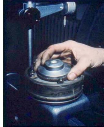
Gambar A.3 Pemasangan landasan dan batupori bagian atas
