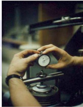
Gambar A.5 Penyetelan arloji ukur gerak vertikal agar tepat menyentuh dudukan sekrup penekan
