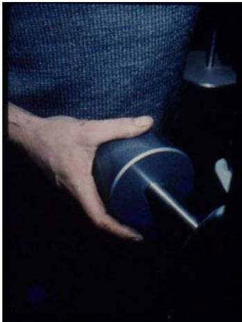
Gambar A.7 Penyetelan beban penyeimbang agar lengan pembeban tetap membentuk sudut 10°
