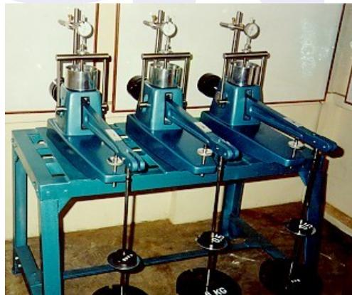
Gambar 3 Contoh rangkaian peralatan konsolidasi (*Oedometer*)
