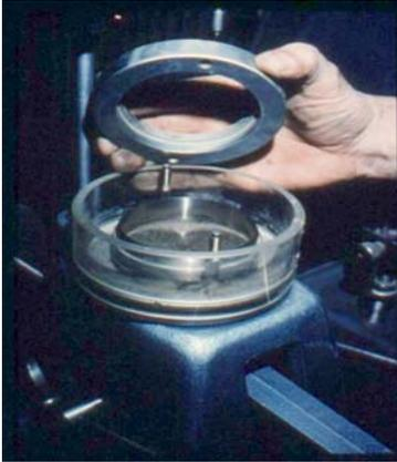
Gambar A.1 Proses pengeluaran cincin cetak benda uji dan pencetakan benda uji
