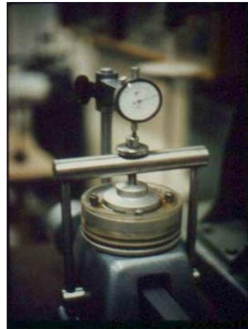
Gambar A.8 Mulai pelaksanaan pengujian konsolidasi dengan membuka kunci lengan pembeban
