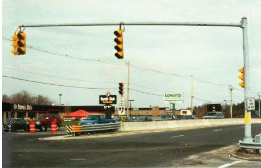
Gambar 6.4 Struktur portal dengan pipa baja [5].
