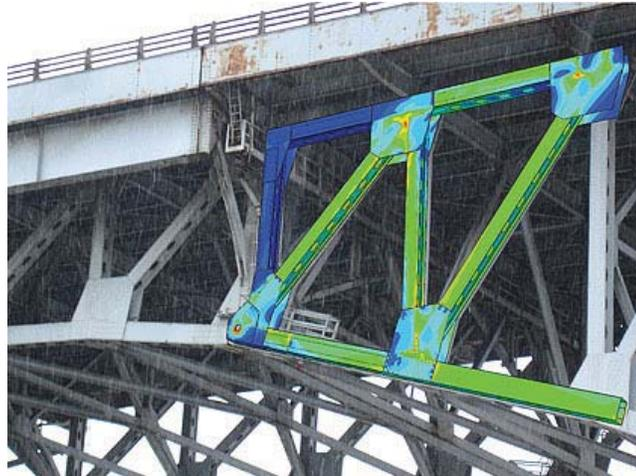
Gambar 1.10 Simulasi numerik untuk mengetahui perilaku tegangan pada struktur jembatan rangka dengan ABAQUS [3].
