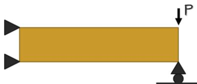
Gambar L1.10 Balok dengan beban terpusat P.
