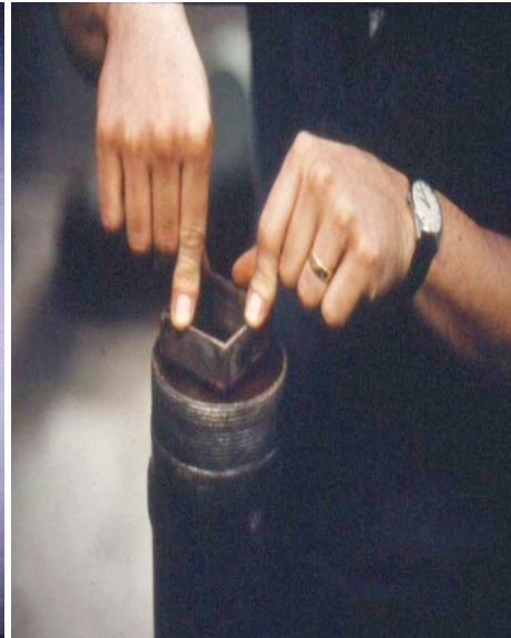
A.8 Pencetakan benda uji dengan cincin cetak
