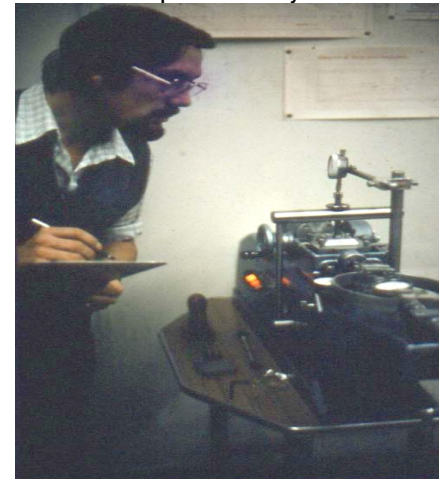
A.21 Proses penggeseran dan pencatatan arloji ukur deformasi vertikal, horizontal dan cincin pembeban
