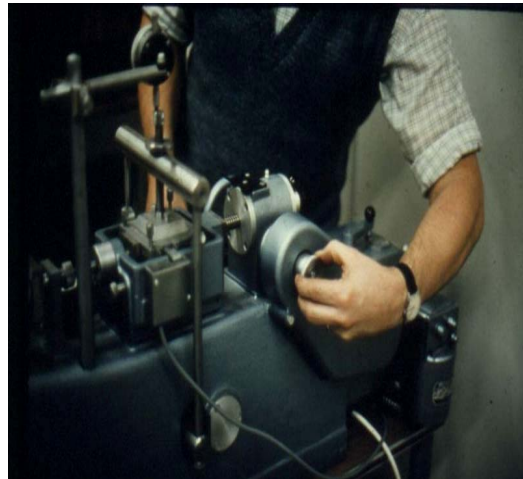
A.20 Penyetelan agar supaya kotak geser menyentuh cincin pembeban sebelum pengujian
