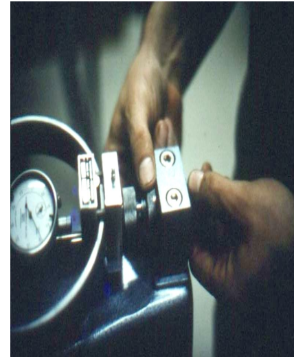
A.17 Penyetelan cincin pembeban dan pemasangan pada dudukannya
