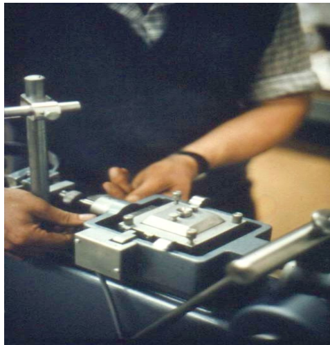
A.11 Pemasangan kotak geser dalam bak air, dan penyambungan dengan sekrup ke
