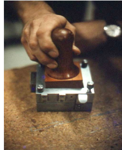
A.9 Pemasangan benda uji dalam kotak benda uji
