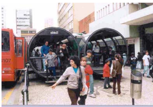
Gambar 4 Di Kuritiba, tabung penumpang mendukung angkutan 5 pintu bus-bus produksi lokal. Pintu membuka ke luar, tangga dijatuhkan agar dapat masuk dari sana juga.
