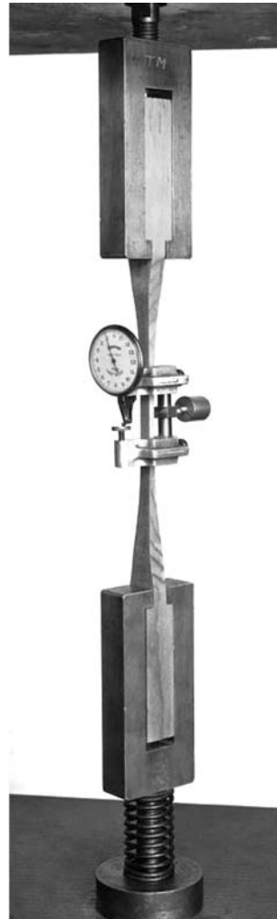
Gambar 5.1 Konfigurasi bentuk grip dan benda uji tarik sejajar serat
