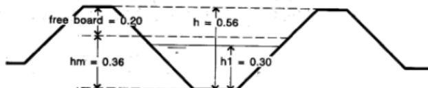
Gambar 2. Saluran berkapasitas lebih kecil (Irrigation and water management manual, 2007)
