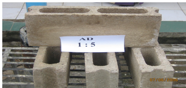
Gambar 2. Batako yang dihasilkan dengan perbandingan
