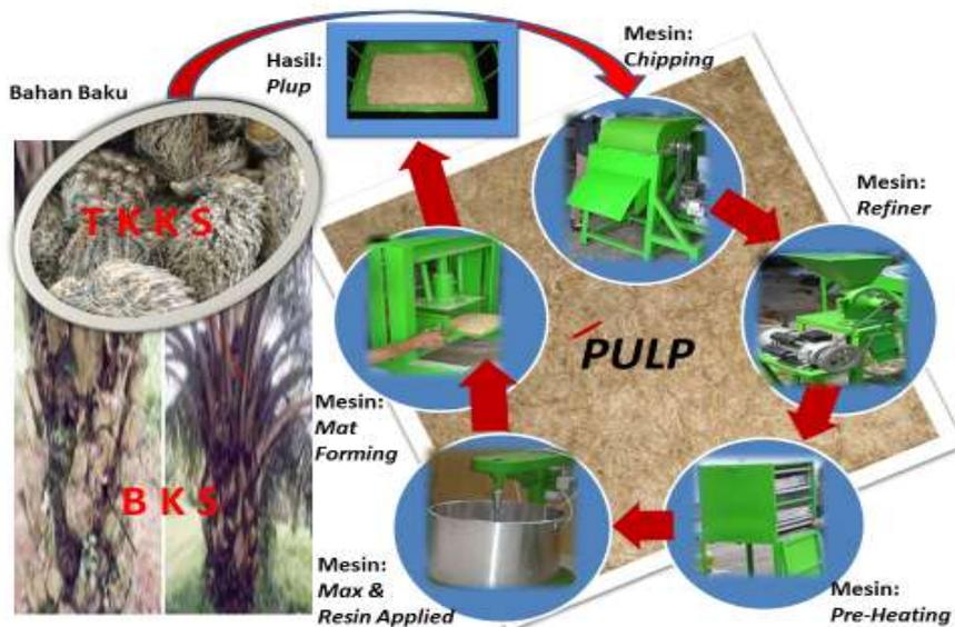
Gambar 2.36. Proses Pembuatan *Pulp*
