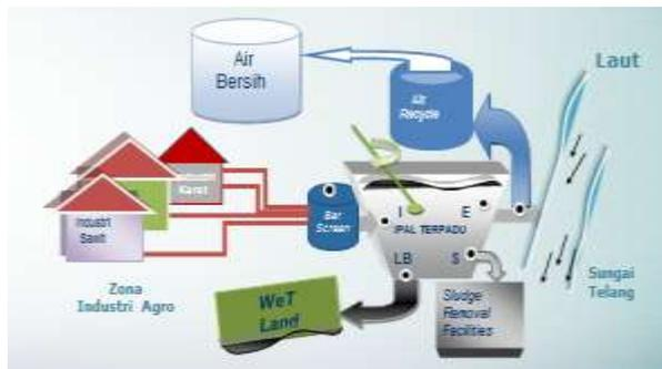
Gambar 2.2 Mekanisme Alur Limbah IPAL Terpadu
