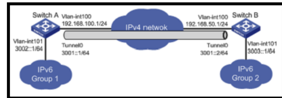
Gambar 1 Metode transisi Tunneling
