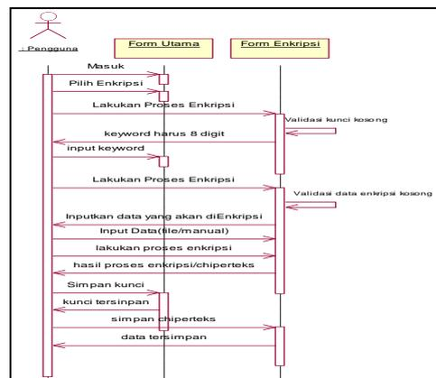
**Gambar 3. Sequence Diagram pada Proses Enkripsi**
