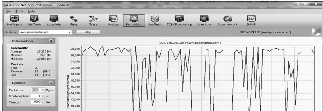
Gambar. 4 Contoh pengukuran *throughput*
