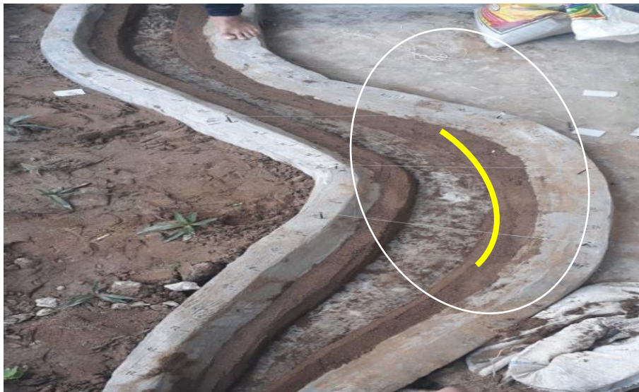
Gambar 2. Sketsa model sungai Komering di laboratorium Hidrolika Universitas Bina Darma
