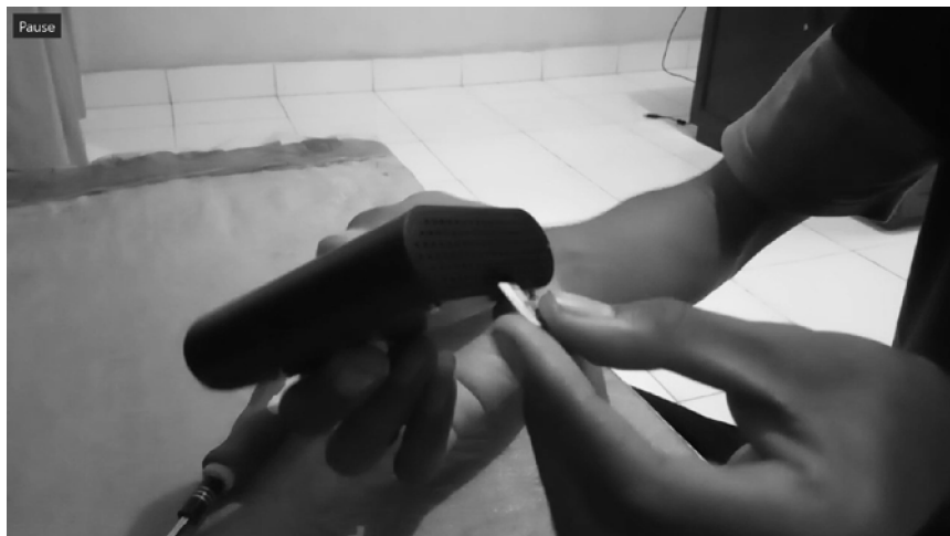
Gambar 4. Pemasangan SD Card pada Raspberry Pi 3
