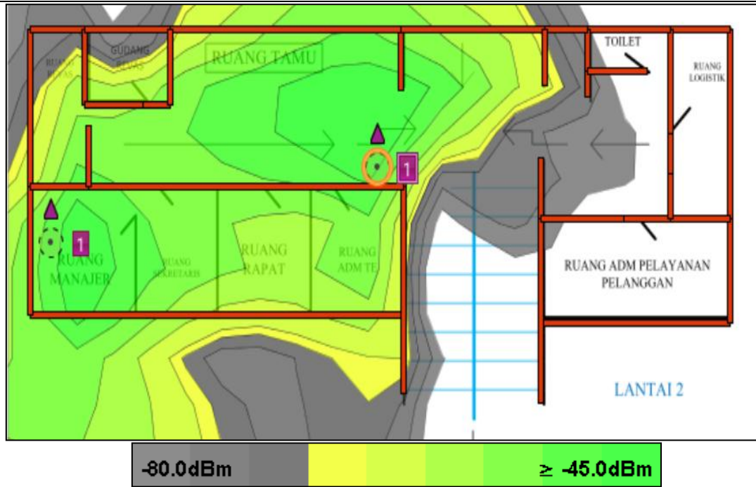
Gambar 2. Pengukuran Cakupan Lantai 2
