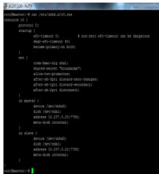
Gambar 4.4 File Konfigurasi DRBD Pada Kedua Server
