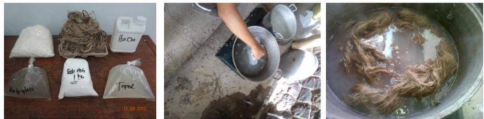
Gambar 2: Foto proses *scouring* benang limbah karung goni
