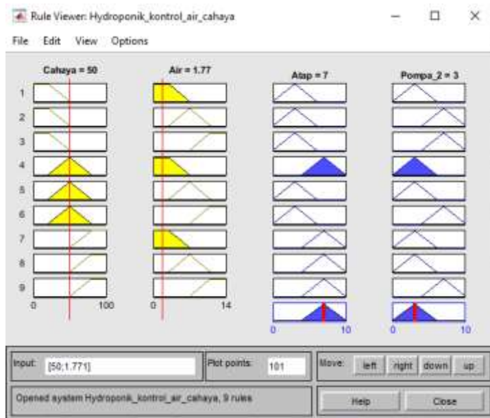
Gambar 14. Simulasi Proses Penentuan Kondisi Output Dengan Matlab
