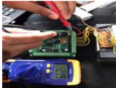
Gambar 11. Hasil Pengukuran Tegangan Catu Daya PLC Outseal
