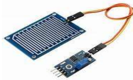
Gambar 9 Sensor Air Hujan
