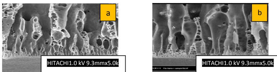
Figure 3. FESEM images of the a) 1 wt.% TiO 2 /PVDF, (b) 2 wt.% TiO 2 /PVDF nanoporous membranes.
