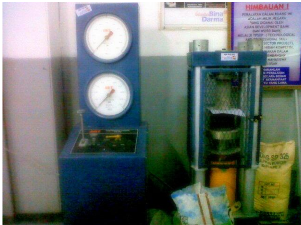
Foro. Proses pengujian kuat tekan beton
