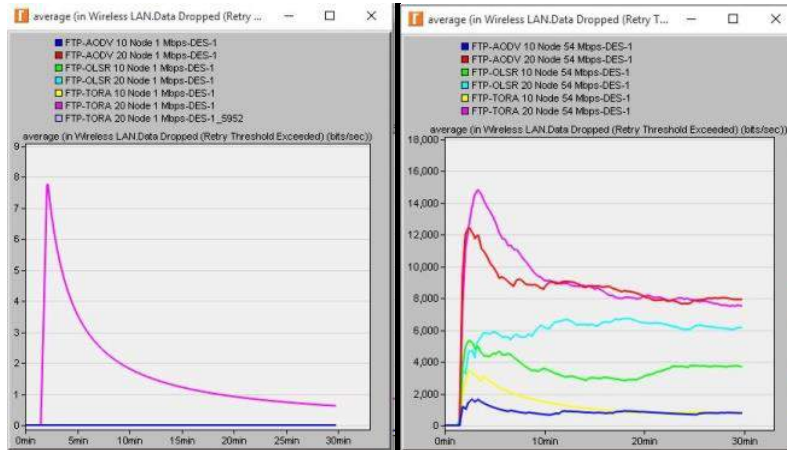
Gambar 3. Data Dropped Load pengujian 1 Mbps dan 54 Mbps
