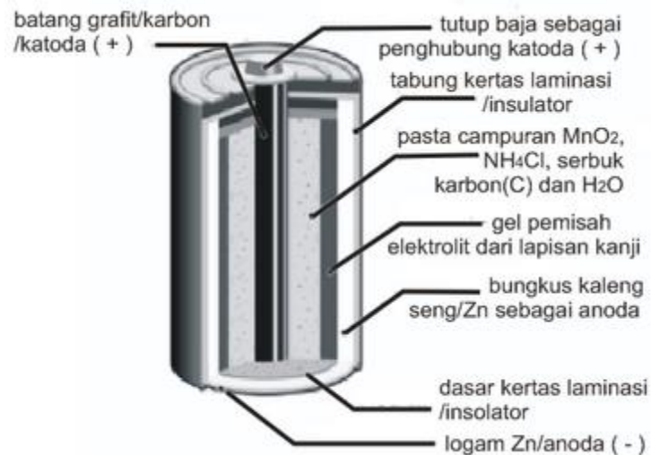
Gambar 7. Batery kering dan bagian -bagian nya
