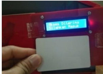
Gambar 11. Pintu terbuka menggunakan RFID
