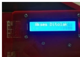
Gambar 13. Pintu terkunci (RFID tag ataupun ketukan tidak terdaftar)
