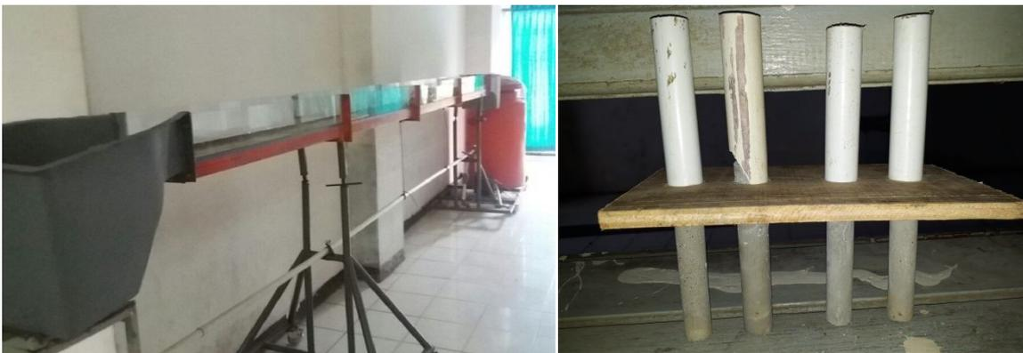
Gambar 1. Model fisik saluran dan model pilar
