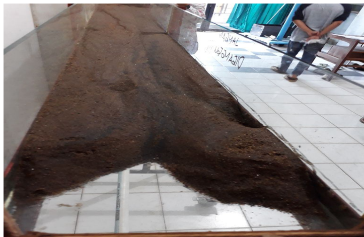
Gambar 5. Pola Sedimentasi pada waktu 90 Menit
