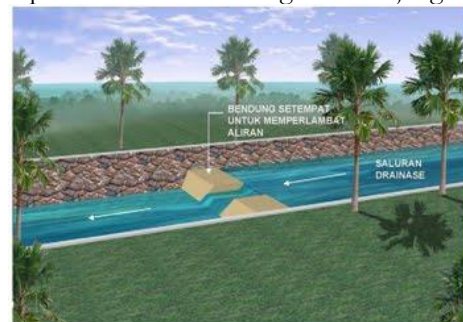
Gambar 3. Tipe kolam retensi storage memanjang (Aditya, 2016).
