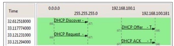
Gbr. 11. Flow graph dhcp paket pada pengujian
