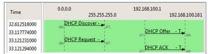
Gbr. 11. Flow graph dhcp paket pada pengujian
