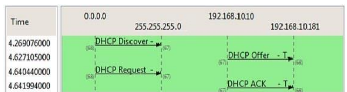
Gbr. 7. Flow Graph DHCP Packets pada Pengujian setelah adanya Rogue DHCP Server
