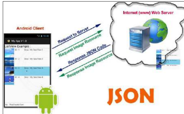
Gambar 2. Konsep mekanisme aplikasi mobile android lowongan kerja
