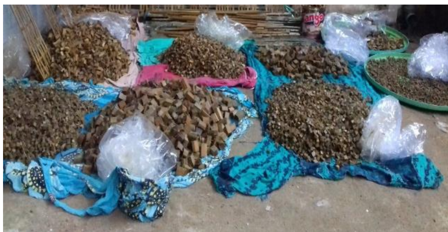
Gambar 1. Potongan agregat bambu berdasarkan ukuran
