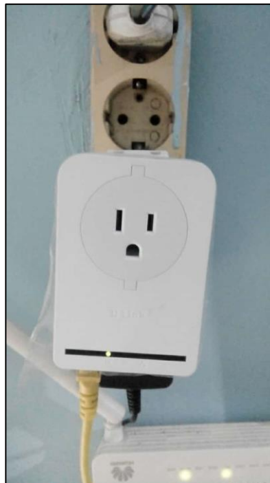
Gambar 2 Perangkat PLC yang terhubung listrik dan LAN
