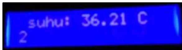
Gambar 12 Hasil Pengujian Sensor MLX90614 (< 37°C)
