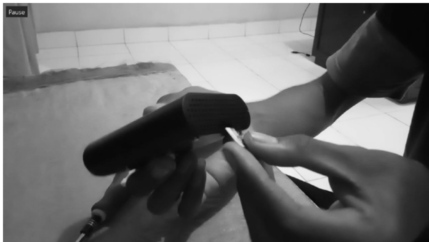
Gambar 4. Pemasangan SD Card pada Raspberry Pi 3
