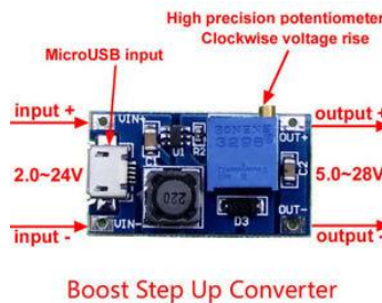
Gambar 8. Konfigurasi MT3608 DC Step Up Module
