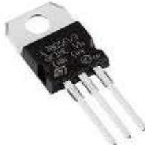
IC regulator 7805 digunakan menurunkan tegangan DC dari baterai / accu yang menuju ke Ardiuno Uno , agar ardiuno bisa berfungsi dengan baik dan bisa menampilkan hasil dari tesla coil ke LCD<sup>[1]</sup>.
