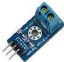
Sensor tegangan disini berfungsi sebagai sensor untuk mengukur tegangan keluaran dari tesla coil.<sup>[3]</sup>
