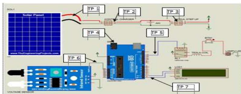
Dilakukan pada 7 titik pengukuran mulai dari sumber tegangan yang masuk dari solar cell, baterai, sensor tegangan sampai dengan tegangan keluaran tesla coil. Dan hasilnya pada tabel berikut.
