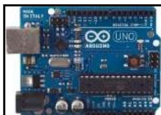
Mikrokontroler pada penelitian menggunakan Arduino uno R3 sebagai pusat pengendali rangkaian,yang memakai tegangan kerja 5 V yang menggunakan arus DC<sup>[1]</sup>.
