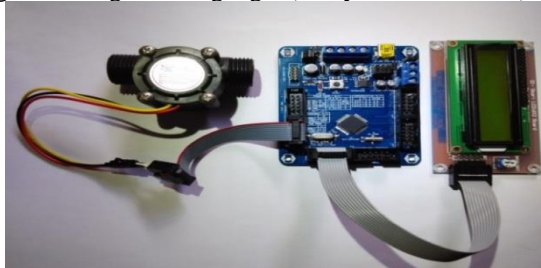
Gambar 3. Rangkaian fisik meteran air digital tanpa regulator tegangan dan baterai
