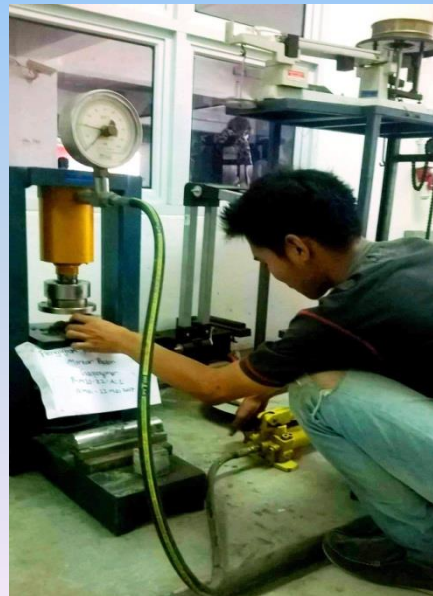
Pengujian kuat tekan mortar beton geopolimer
